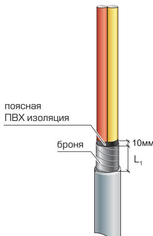
**2.1** Снять с кабеля оболочку и бронеленты со-
