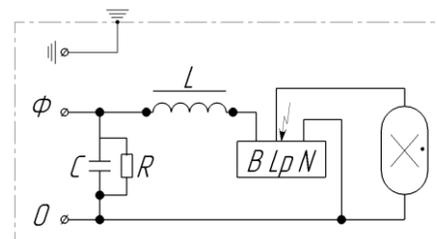
Рисунок 2 - Схема подключения ЖБУ02-50-003
