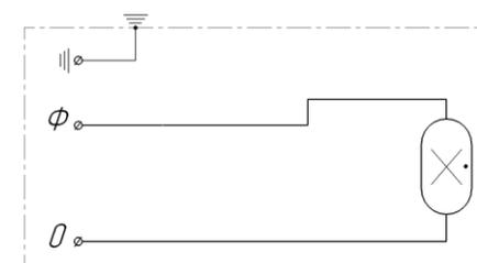
Рисунок 3 – Схема подключения для ЛБУ02...003
