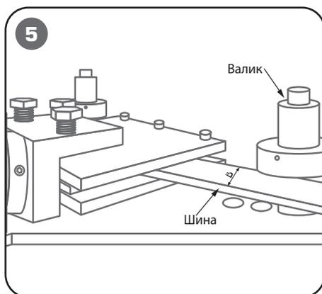
Установите обрабатываемую шину в оправку. Ориентируясь по шкале для гибки на ребро, установите упорные валики в отверстия, соответствующие ширине шины (Размер В). Отрегулируйте резьбовой втулкой высоту паза на упорных валиках, чтобы шина свободно базировалась по шлицам.
