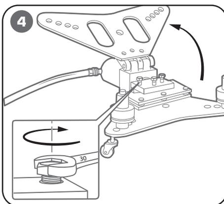
Зафиксируйте оправку с профилем в инструменте установочными болтами.
