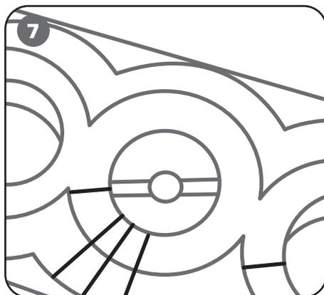
Поверните упорные валики так, чтобы метки на них были в положение «0» на угловой шкале для гибки на ребро.
