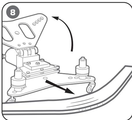
Работая помпой, согните шину под нужным углом. Контролируйте угол по шкале для гибки на ребро. По окончании, сбросьте давление. Откройте верхнюю плиту. Извлеките готовую шину
