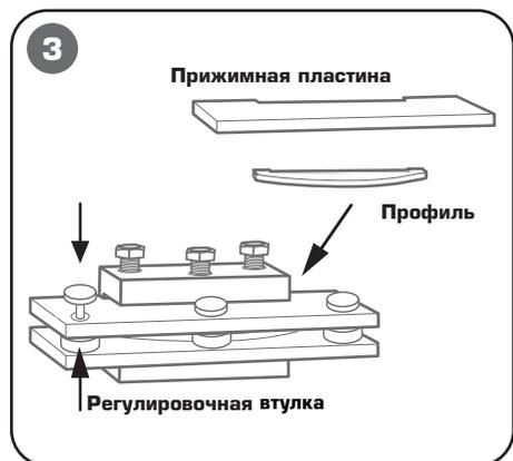
Установите в оправку профиль нужного типоразмера для гибки на ребро, а также регулировочные втулки в зависимости от толщины шины. Поверх установите прижимную пластину.
