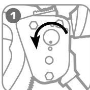
Разблокируйте рукоятки, повернув фиксатор разблокировки.
