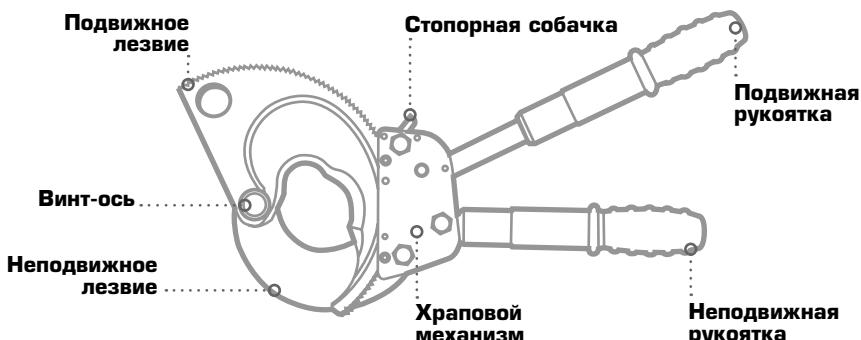
Ножницы секторные состоят из лезвий подвижного и неподвижного, храпового механизма, стопорной собачки и телескопических ручек
